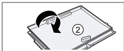
3. Tirar de las sujeciones inferiores de la cubierta inferior.
